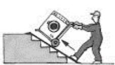
2. **Plano inclinado** Es una superficie inclinada con un cierto ángulo sobre la horizontal, utilizada para levantar grandes pesos con poco esfuerzo.
