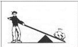
1. **La palanca:** Es una barra rígida con un punto de apoyo, a la que se aplica una fuerza y que, girando sobre el punto de apoyo, vence una resistencia. Existen tres tipos de palancas.
