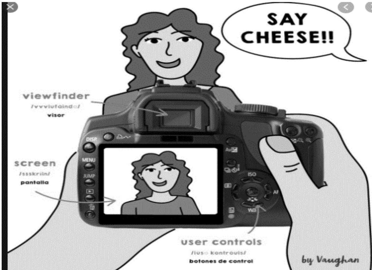
Una **cámara fotográfica** o **cámara** de fotos es un dispositivo utilizado para capturar imágenes o fotografías. ... La mayoría de las **cámaras fotográficas** tienen un objetivo formado de lentes, ubicado delante de la abertura de la **cámara fotográfica** para controlar la luz entrante y para enfocar la imagen, o **parte** de la imagen.
